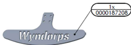
Abb. 6 Laserzuschnitt aus 3 mm Edelstahl (stainless steel)
